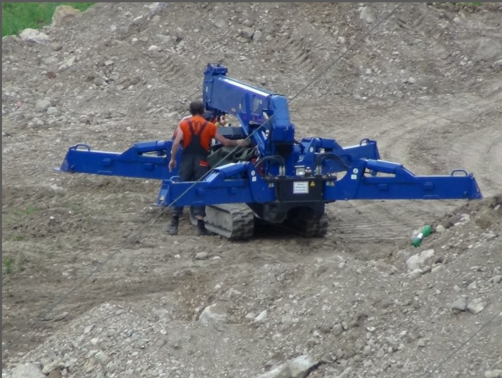
Nohy sa spustia na zem, a vysunie sa výložník.
